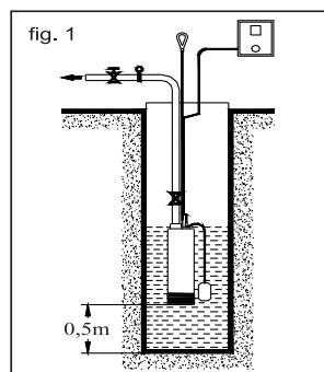
**AVVISO:** Si raccomanda e si consigliabile di installare una valvola di ritegno nella mandata della pompa per evitare depositi, e una valvola di controllo facilmente raggiungibile per permettere una facile rimozione della pompa, per operazioni di pulitura e manutenzione.
