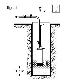
**Opmerking:** het wordt aangeraden om een afsluitkraan en een terugslagklep met gemakkelijke toegang te plaatsen .
