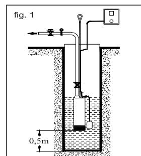
**Avertissement :** Il est conseillé d'installer une vanne de sectionnement ainsi qu'un clapet aisément accessible. La pompe sera plus facile à déposer pour les opérations de nettoyage et d'entretien.
