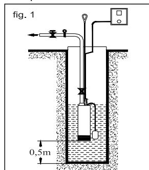
**NOTA:** Se recomienda la instalacion de una valvula de retencion en la salida de la bomba, para mediante una tuerca de union, poder acceder facilmente a las posibles operaciones de cuidados y mantenimiento.
